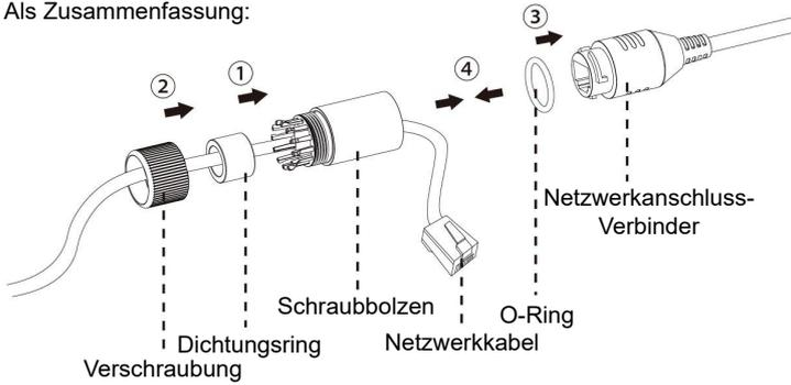
**WICHTIG:** Prüfen Sie, ob alle Dichtungen korrekt aufliegen und ob alle Öffnungen und Kabeleinführungen sicher verschlossen sind, sodass keine Feuchtigkeit in die Anschlussbox eindringen kann.
