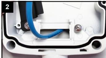
Verkabelung in die Box einführen und die Box an Wand oder Decke montieren.
