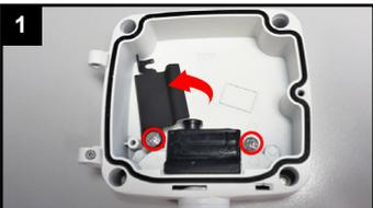
Schrauben ein wenig lösen und schwarze Platte Seite schwenken.
